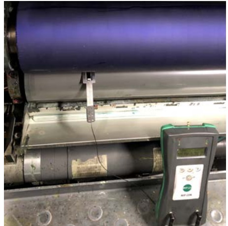
Walzenjustage mit dem NIPCON-Gerät
